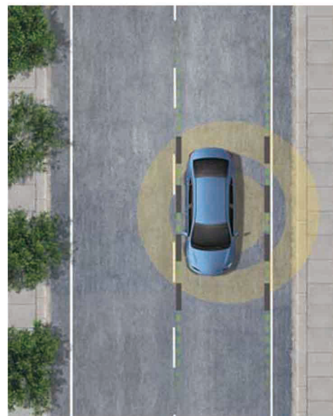
轉向車道偏離警示輔助系統(LDA)
