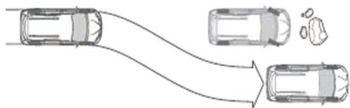
防鎖死煞車系統(ABS)示意圖
